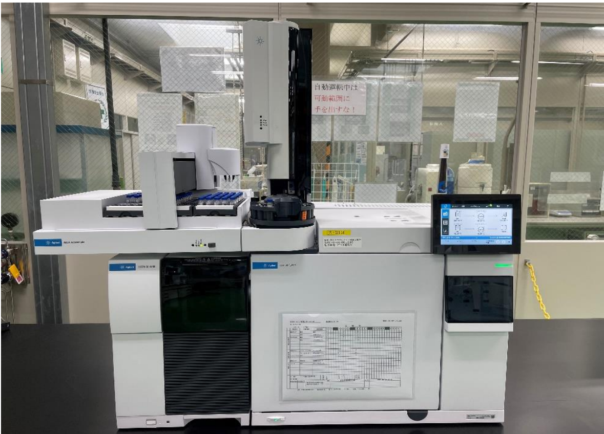
VOC分析装置 装置名：GC/MS5977B(Agilent Technologies社製)
