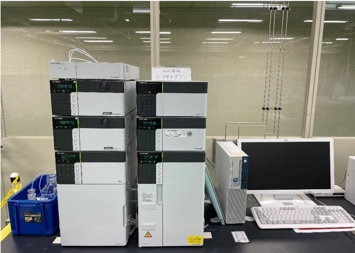
アルデヒド類分析装置 装置名：HPLC Prominence(島津社製)
